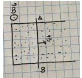
**EJERCICIO 7:** Una espira cuadrada de lado 10cm se traslada con una velocidad constante de 1m/s en dirección perpendicular a las líneas de un campo magnético uniforme de 2T. Determina la fem inducida en la espira cuando ésta sale del campo magnético.
